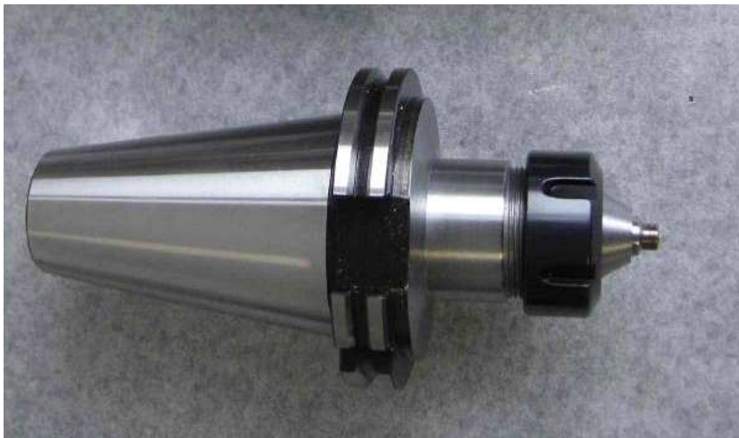
Bild 1: Werkzeugvorsatz für Blechdicke 1 - 2,5 mm
