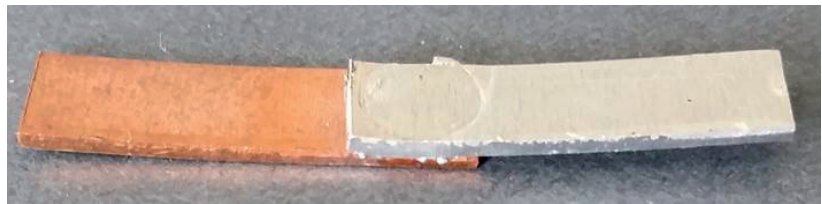
Punktförmige Verbindung zwischen Cu- und Al-Blechen
