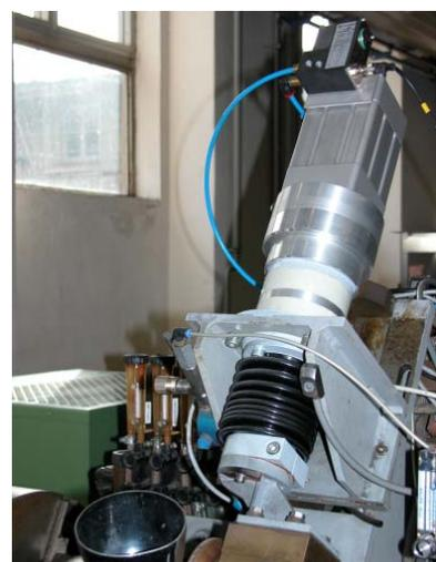
Elektrodenantrieb für Kraftmodulation, re.
