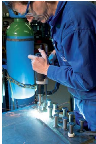
Hubzündungsbolzenschweißen mit Keramikring an 19 mm Kopfbolzen
