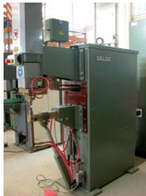
Punktschweißmaschine mit servomotorischem Antrieb Fa. Dalex
