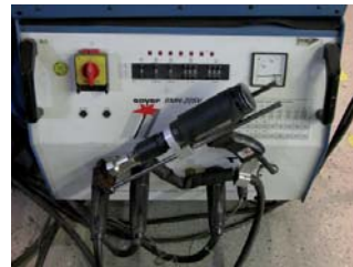
Hubzündungsbolzenschweißen mit Keramikring an 19 mm Kopfbolzen
