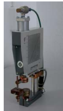
Feinpunktschweißmaschine Fa. Messer Griesheim
