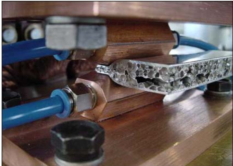
Werkzeug zum Randverdichten von Al-Schaum-Sandwich, montiert in einer Buckelpresse
