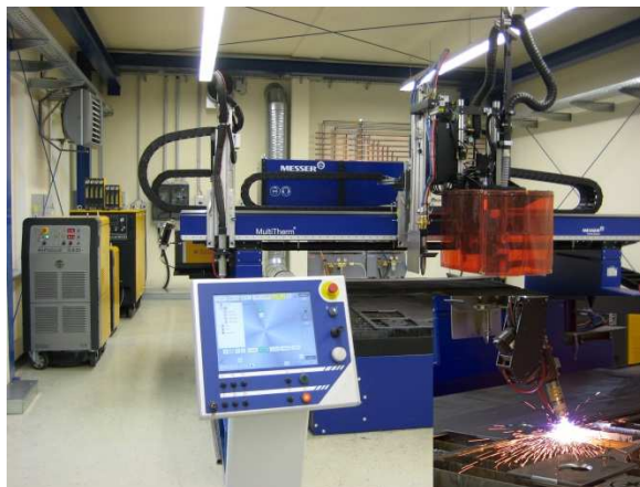
Abbildung 1: Plasma- und Brennschneidanlage zur Schweißkantenvorbereitung
