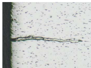
Wolframelektrode nach 100 Schweißungen von verzinnem Kupfer (Elektrodenarbeitsfläche)
