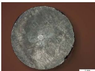
Wolframelektrode nach 100 Schweißungen von verzinnem Kupfer (Elektrodenarbeitsfläche)
