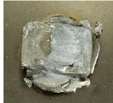
Die Bilder zeigen Bruchbilder einer Schälzugprobe zwischen EN AW-6016 T4 und 22MnB5 (links) und einer Scherzugprobe zwischen EN AW-5754 H12/22 und Titan Grade 2 (rechts) als Vertreter für weitere, über den Stahl hinaus gehende, Einsatzmöglichkeiten.
