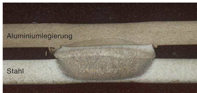
Das Bild zeigt eine Verbindung im Makroschliff. Der Spalt ist charakteristisch für das Verfahren und kann zur Aufnahme von Kleb- und Dichtstoffen dienen.
