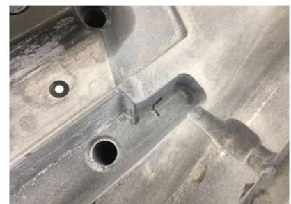
*Oberflächenrisse und abrasiver Verschleiß in Aluminiumdruckgussform aus warmfestem Stahl 1.2343*
