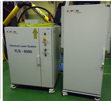
Ytterbium Faserlaser 6 kW mit Kühler (rechts)
