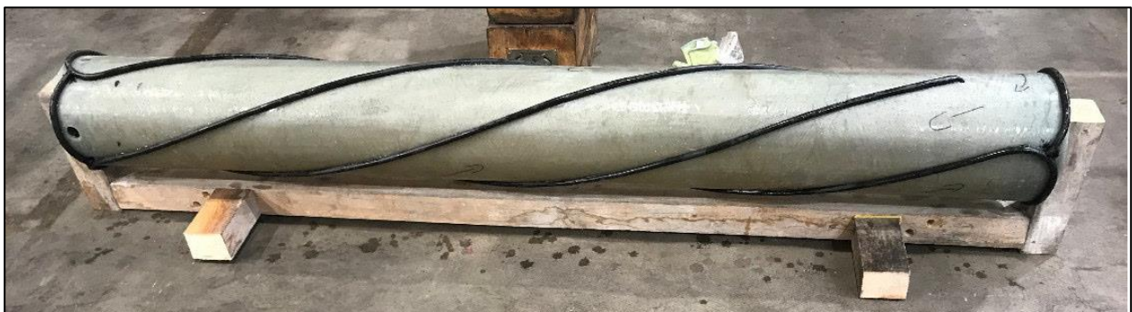
Abbildung: Kunststoffinnenrohr der Hybridwalze mit elastischen Polymerdichtungen zur Medienführung
