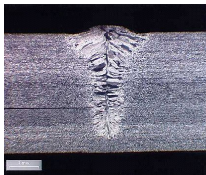
Schliffbilder von typischen laserstrahlgeschweißten Nähten links: Überlappnaht, rechts: I-Stoß
