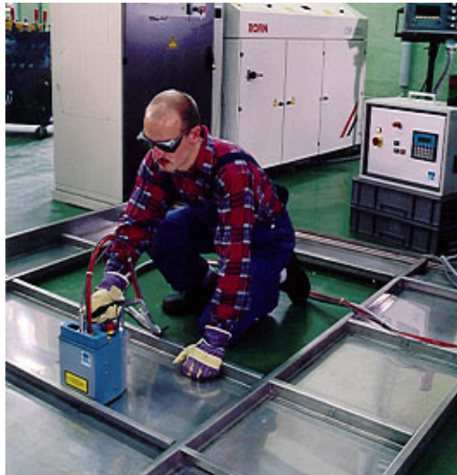
Einsatz im Schienenfahrzeugbau - Schweißen großer Dünnpblech- konstruktionen
