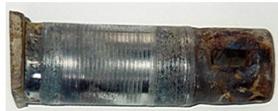
Bolzen, rollennaht-auftraggeschweißt beide nach gleicher Förderleistung (394 Einheiten) Werksfoto MIBRAG Theißen
