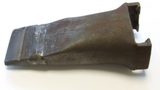
Regenerierter Reißzahn mit Plasma-Pulver-Verschleißschutzschicht (NiBSi+WC)
