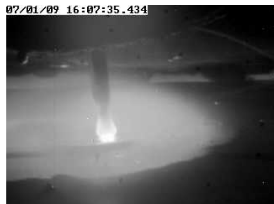
Bild 2: Tropfenübergang beim gepulsten MIG-Löten
