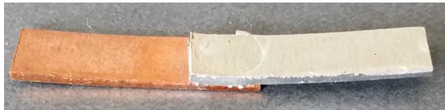
Punktförmige Verbindung zwischen Cu- und Al-Blechen
