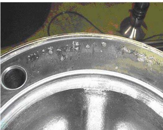
Kolbenschäden aufgrund korrosiver und tribochemischer Angriffe
