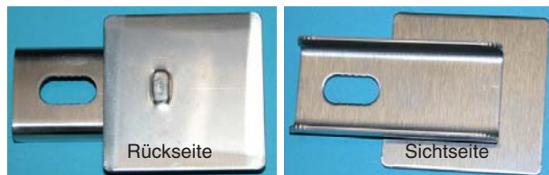
Bild 2: Punktlöten austenitischer Stähle
