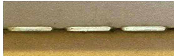
Gleichmäßige Heftnahtqualität durch das Heftnahtschweißgerät
