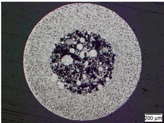
Querschliff einer technologisch untersuchten Fülldrahtlegierung
