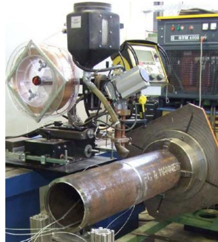
Versuchsaufbau zum MAG-, UP-, MSG-Schweißen
