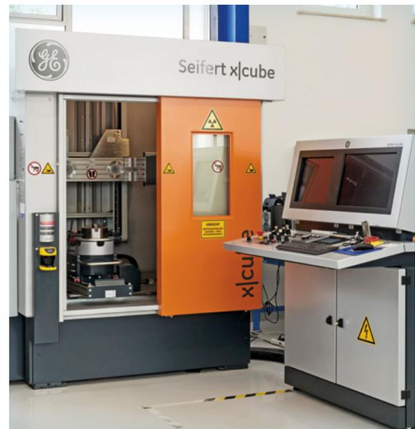
Ermöglicht radoskopische Materialprüfungen in Bewegung: Die neue Röntgenvollschutzkabine.
