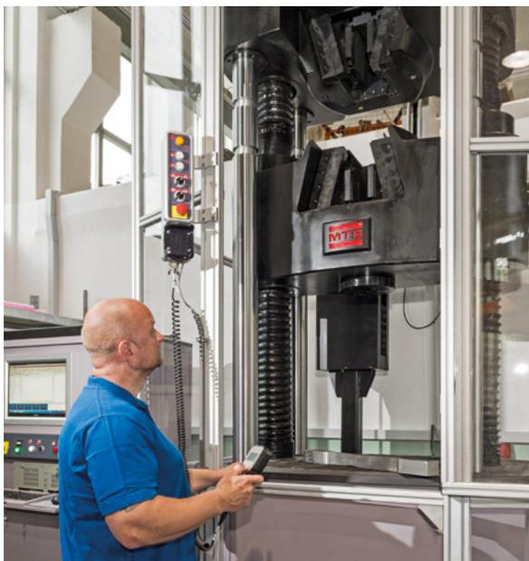
SLV-Mitarbeiter Mario Tholen bedient die Universalprüfmaschine, mit der Produkte, Bauteile, Materialien und Werkstoffe auf Belastbarkeit bis zu 200 Tonnen geprüft werden.
