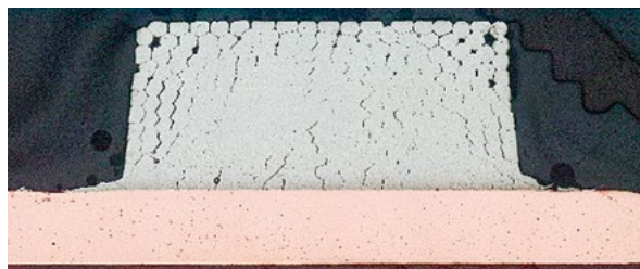
Verbindung der widerstandsgeschweißten 59 mm 2 -Aluminiumlitze mit dem Kupferableiter im metallographischen Schliff.
