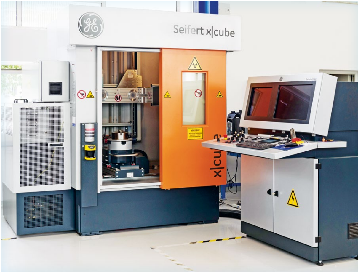
Ermöglicht radoskopische Materialprüfungen in Bewegung: Die neue Röntgenvollschutzkabine.
