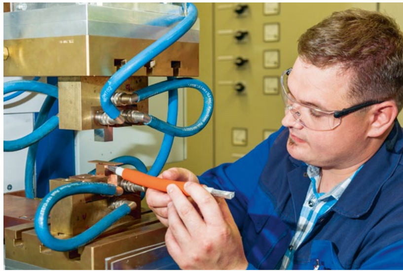
Alexander Dumpies bei der Arbeit am Versuchsaufbau zum Widerstandslitzenschweißen.
