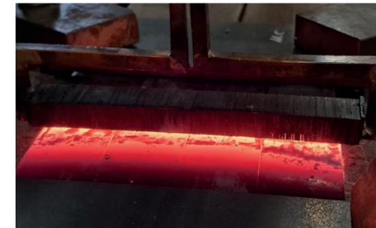
Abbildung 2: induktive lokale Normalisierung der WEZ
