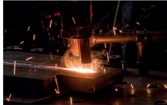
Abbildung 1: MAGr-Prozess (Verfahrensprüfung; DY-Naht; t25)
