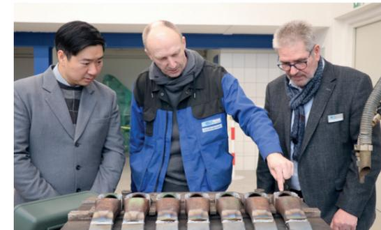
v. l. n. r. Prof. Dr. Kittichai Sojiphan, Uwe Mückenheim und Axel Börnert bei einer Demonstration des vollmechanischen MSG-Schweißens mittels Roboter. Hier werden aktuell Zahnspezialitäten von Tagebaugroßgeräten regeneriert © SLV Halle GmbH
