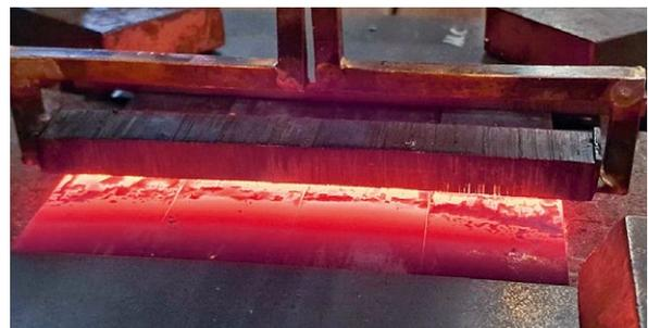
Abbildung 2: induktive lokale Normalisierung der WEZ.
