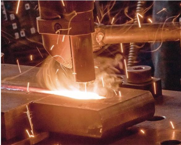
MAGr-Prozess (Verfahrensprüfung; DY-Naht; t25).
