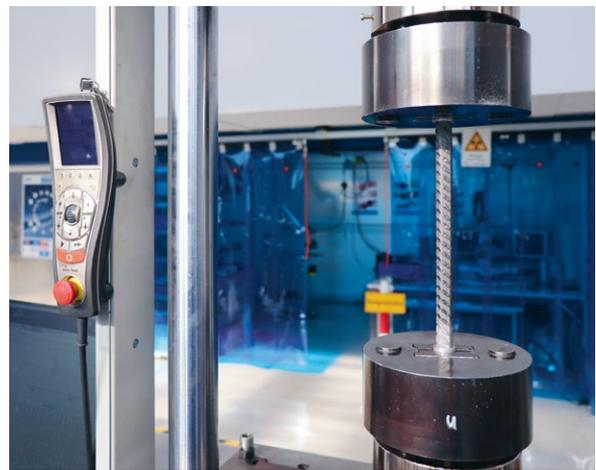
Hochfrequenzpulsatoren (Oberlasten), HFP1: 50 kN.
