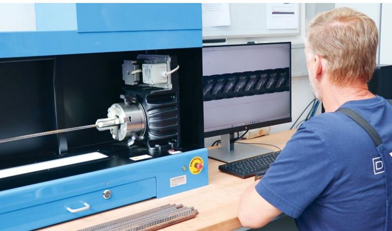
Messgerät zur Bestimmung der Rippenhöhe und -abstände von Betonstahl.
