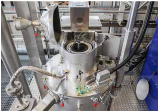
Verdüsungsanlage für pulverförmige Zusatzwerkstoffe (Bild: SLV Mecklenburg-Vorpommern)
