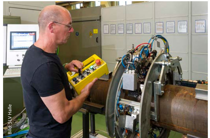
Erfolgsmodell: Laserorbitalzange (LOZ I) in der SLV Halle
