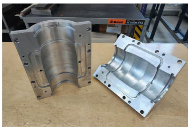
Endbearbeiteter Werkzeug-Prototyp © SLV Halle GmbH
