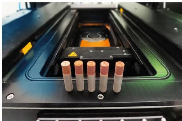
Pulverbett-gefertigte Stahl-Kupfer-Proben © SLV Halle GmbH
