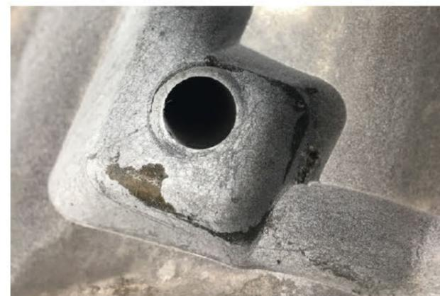
Fotografie des gesamten Auswerferbereichs einer gebrauchten Aluminiumdruckgussform © SLV Halle GmbH
