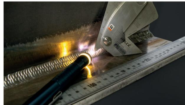
Begutachtungssituation einer Kehlnaht mit 4-Skalen-Schweißnahtlehre © SLV Halle GmbH
