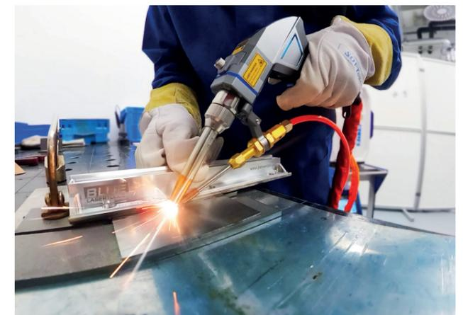
Handgeführtes Laserstrahlschweißen © ifw Jena GmbH
