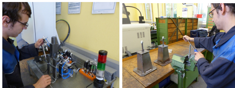
Konstruktionsmechaniker beim Justieren einer Pneumatikanlage sowie beim Anfertigen von Bauteilen.
