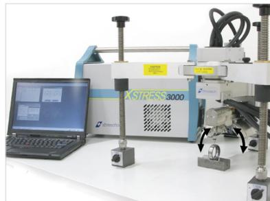
Abbildung 1: Röntgendiffraktometer
