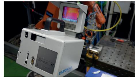
Aufnahme eines Thermogramms bei einem automatisierten Schweißprozess
