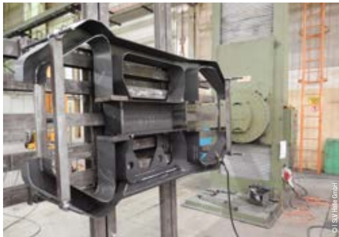
Abb. 1. Fertigung Radträger in Vorzugslage
