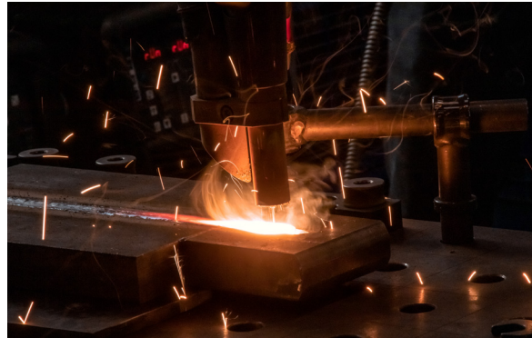
Abbildung 1: MAGr-Prozess (Verfahrensprüfung; DY-Naht; t25)
