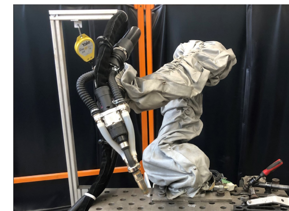
Anwendungsszenario einer Schieneninstandsetzung am MRK-Kleinroboter
