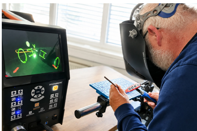
| Bernd Dreyer im virtuellen WIG-Schweißversuch mit Zusatzwerkstoff © SLV Halle GmbH
